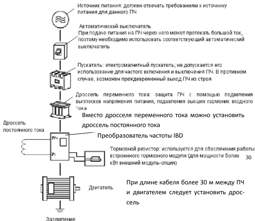
4-1 Схема электромонтажа основного силового контура
