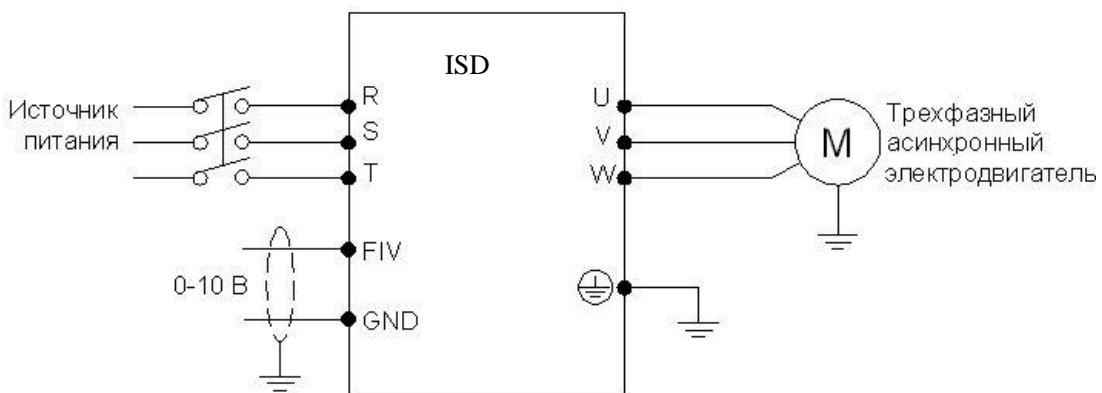
Аналоговое напряжение 0-10В можно сформировать внешним потенциометром 10кОм. Изменение частоты происходит при изменении напряжения от 0 до 10 В между клеммами FIV и GND:
