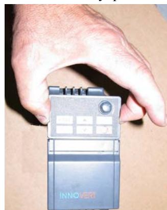
Нажать пальцами на боковые фиксаторы панели и потянуть её на себя.
