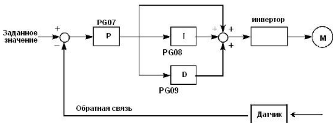
Замечания по использованию преобразователя в режиме PID-регулирования:
