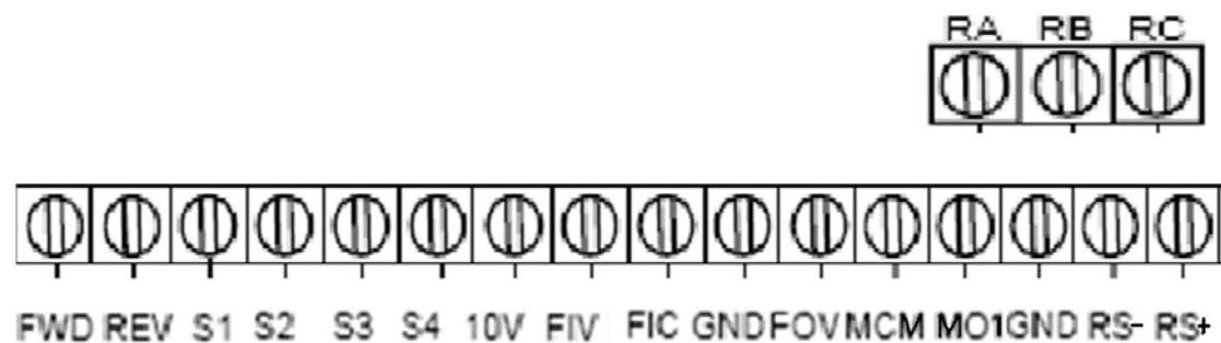
Момент затяжки винтов на клеммах RA, RB, RC - 0.4 Нм.
