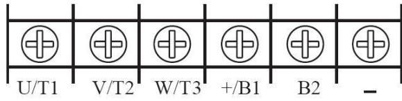
Тип корпуса 3. Трехфазные, 380 В, мощностью от 7,5 кВт до 11 кВт:
