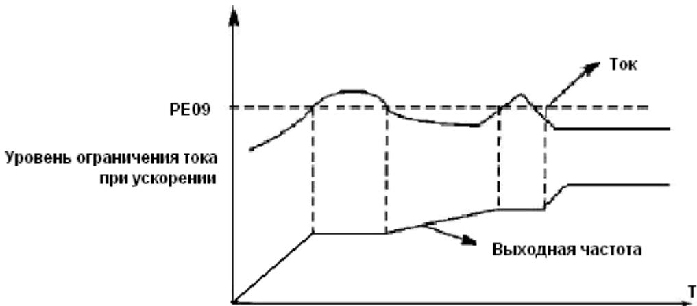
Величина тока перегрузки 100% соответствует номинальному току ПЧ (т.е. предельно возможной величине параметра РС10 в диапазоне допустимых значений). Защита отключена при РЕ09=0.
