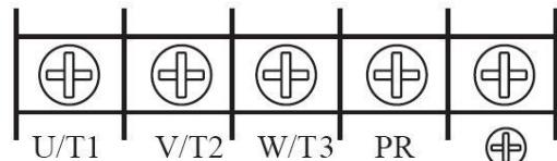
Тип корпуса 2. Трехфазные, 380 В, мощностью от 3,0 кВт до 5,5 кВт, а также однофазные, 220 В, мощностью от 2,2 кВт до 3,7 кВт:
